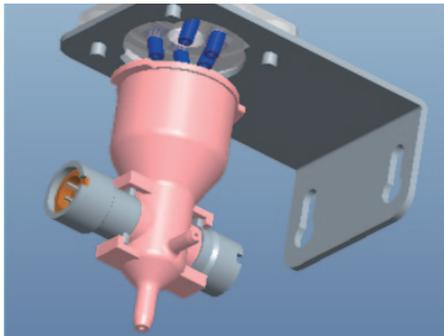
Se utiliza tecnología de impedancia de CC mejorada para realizar el conteo y la medición de RBC y PLT. Las aberturas de conteo más pequeñas (50  $\mu\text{m}$  de diámetro) proporcionan un mejor rendimiento en muestras con bajo PLT.
