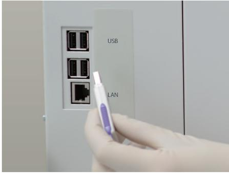
En el costado izquierdo del instrumento, encontrará 4 puertos USB. Estos permiten que los usuarios del BC-5000 transmitan datos de forma conveniente, además de la conexión con impresoras, teclado, mouse, lector de código de barra, etc.
